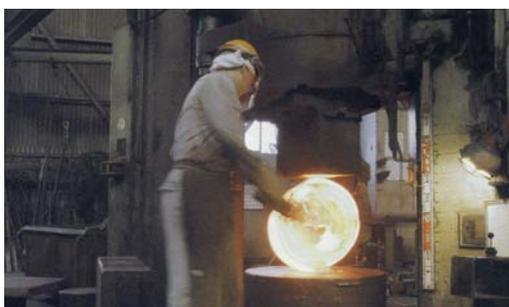
500ton プレスで鉄鋼リング鍛造中
